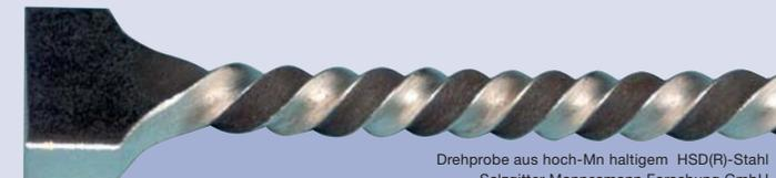
Drehprobe aus hoch-Mn haltigem HSD(R)-Stahl
